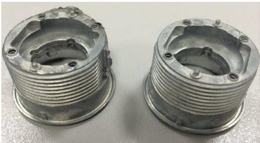
Composant en aluminium moulé sous pression ébavuré
