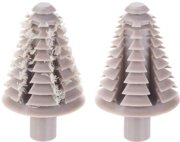
PEEK Werkstück entgratet
