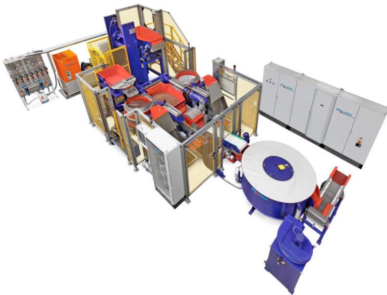
Verkettete Gleitschleifanlage mit einem neuen Verfahren für die Kettenindustrie.
